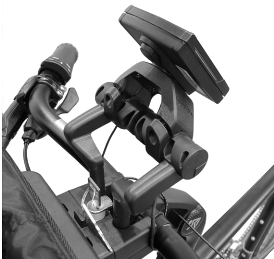
Fixation de l'ordinateur de bord de vélo électrique
